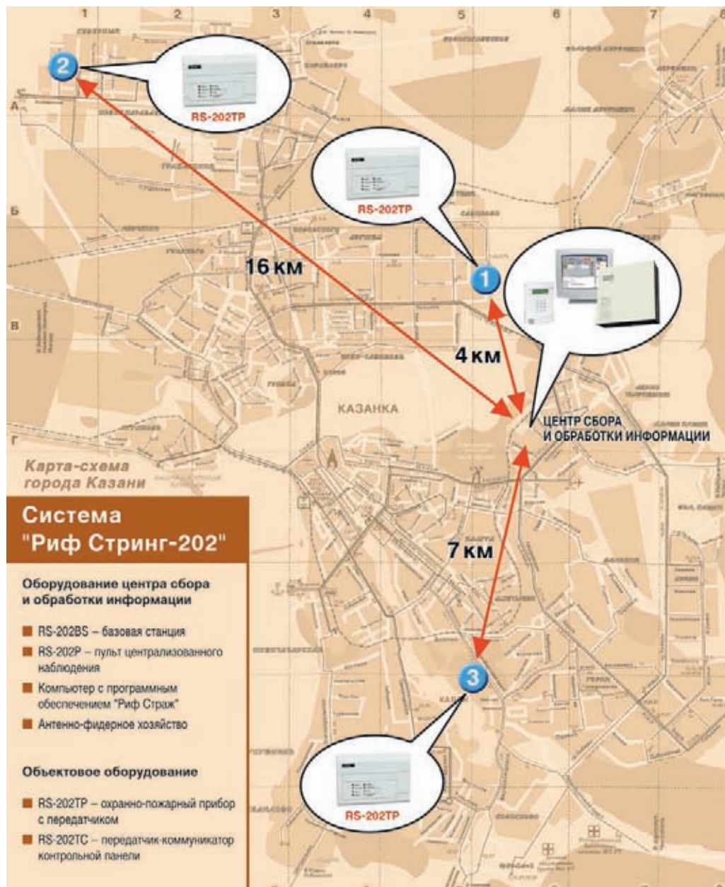
Расположение оборудования радиоканальной системы централизованной охраны "Риф Стринг-202" на испытаниях в Казани
