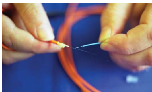
Фото 4. Нанесение клея (ST-коннекторы)
