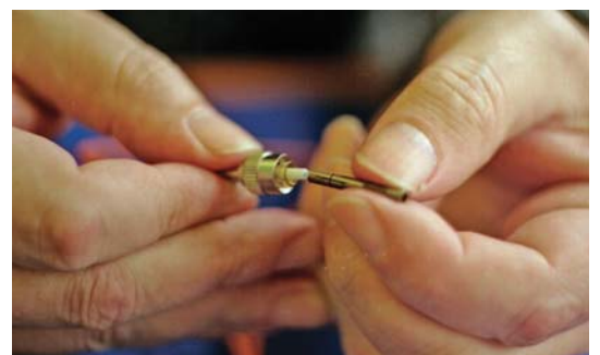
Фото 10. Установка защитной втулки
