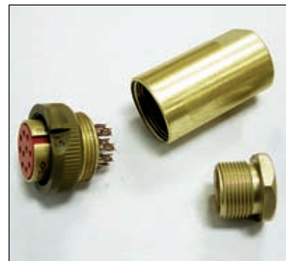
Разъем РС-10 Розетка. Распаивается на кабель. Корпус заполняется герметиком
