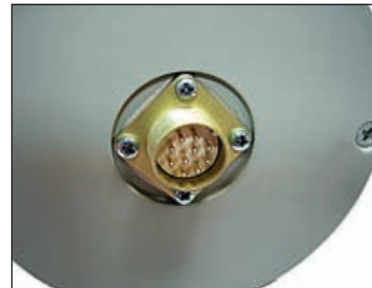
Разъем РСГ-10 Вилка Устанавливается на гермобокс
