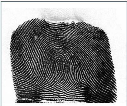
**в)** Отпечаток потного пальца, полученный на сканере, имеющем функцию исключения влияния влаги
