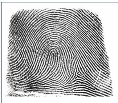
**б)** Отпечаток потного пальца, полученный на сканере, не имеющем функцию исключения влияния влаги
