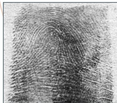
**б)** Отпечаток сухого пальца со сканера без эластичного покрытия призмы
