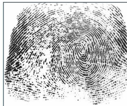
**в)** Отпечаток сухого пальца со сканера с эластичным покрытием призмы
