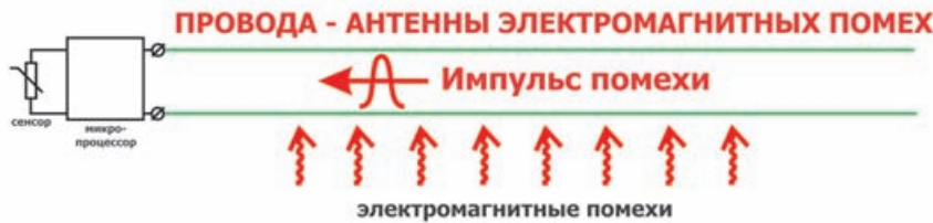
Рис. 6. Воздействие электромагнитных помех на проводные пожарные извещатели
