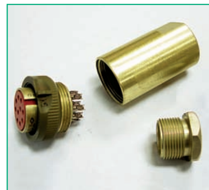
Рис. 5. Кабельная часть разъема РСГ-10 – розетка
