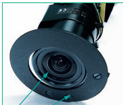
Рис. 9. Типовое решение обогрева стекла гермобокса
