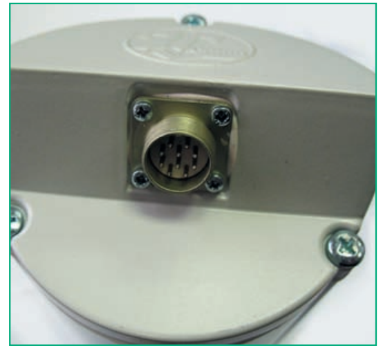
Рис. 4. Задняя стенка бокса с разъемом РСГ-10 – вилка
