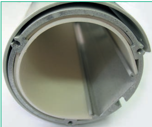
Рис. 8. «Утепление» гермобокса изолятором
