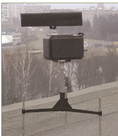
Рис. 1. Радиолокационная станция охраны периметра (РЛС)
