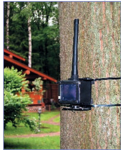
Рис. 9. Беспроводной пассивный ИК-датчик системы «Автогارد»
