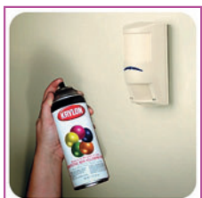
Рис. 3. Маскирование извещателя распыляемой краской
