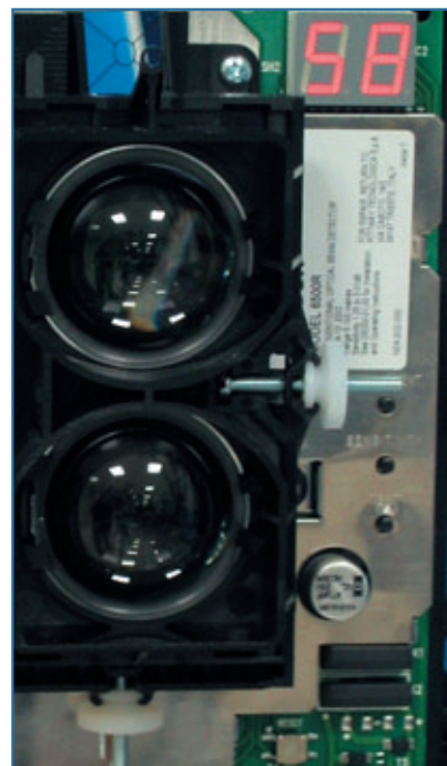
Рис. 9. Зеркальный оптический «прицел» и цифровая индикация уровня сигнала
