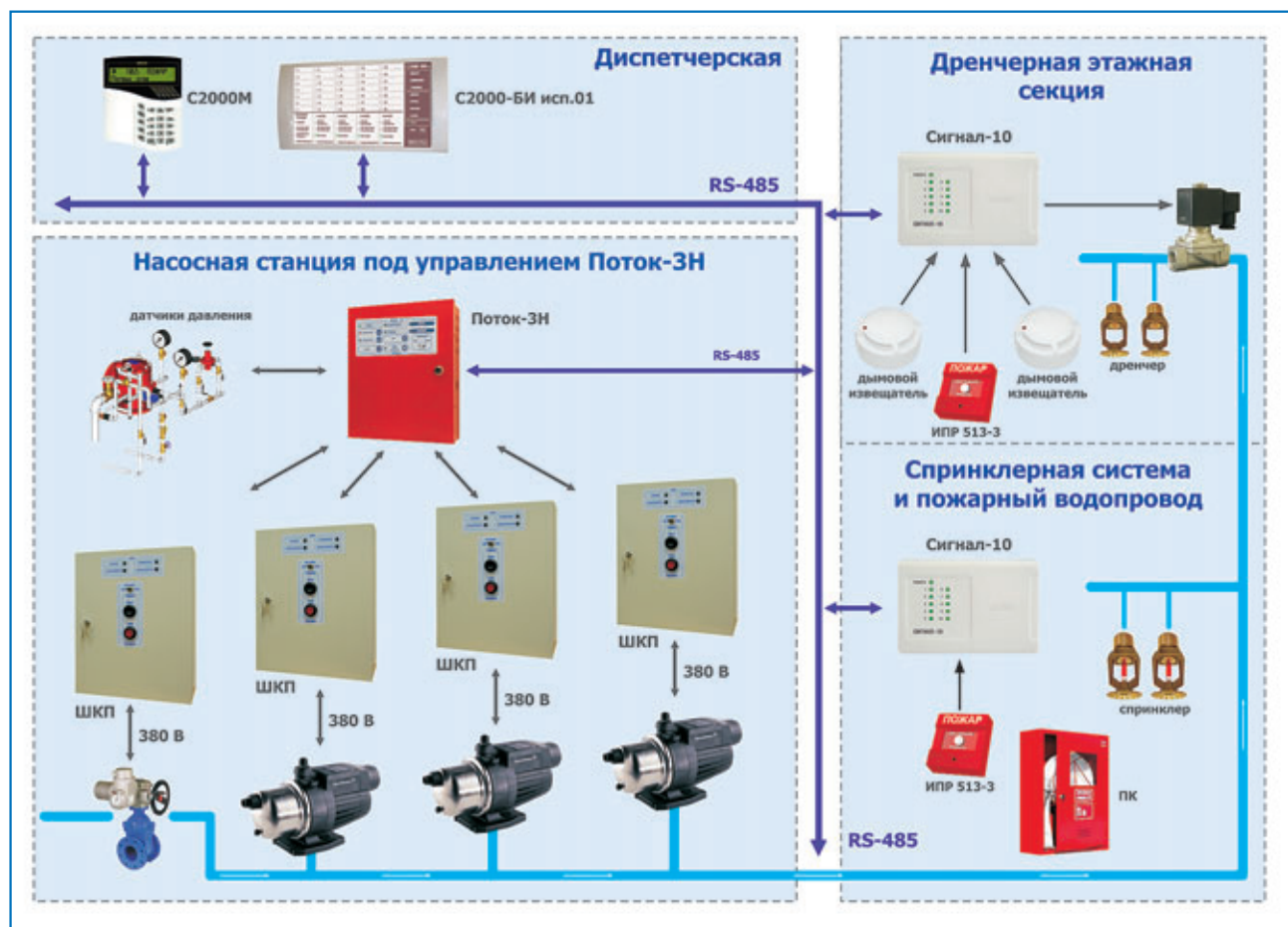
Рис. 1. Система водяного пожаротушения
