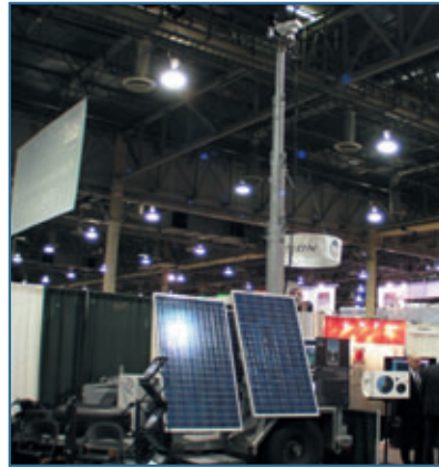
Рис. 9. Мобильная телевизионная установка с питанием от солнечных батарей фирмы (слева) и 5-камерная установка с дизель-генератором на стенде фирмы WANCO (справа)
