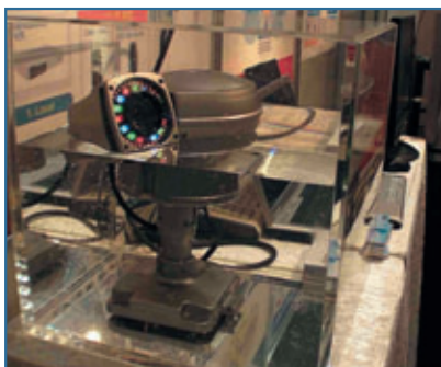
Рис. 6. Водонепроницаемый скоростной поворотный комплекс со светодиодной подсветкой
