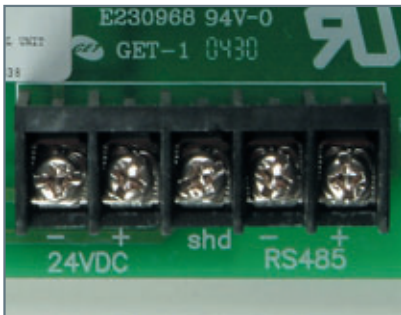
Рис. 6. Точка подключения экранировки линии RS485 (shd)
