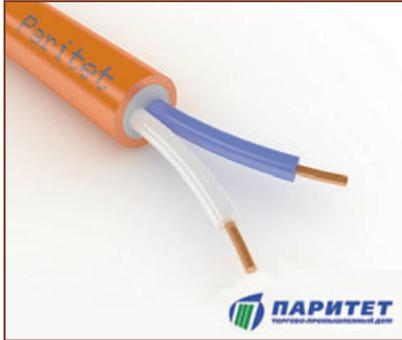
Кабели огнестойкие для электрических установок систем противопожарной безопасности, сохраняющие работоспособность в условиях пожара в течение 180 мин. с изоляцией из керамизирующейся кремнийорганической резины и оболочкой из термопластичной безгалогенной композиции пониженной пожарной опасности.
