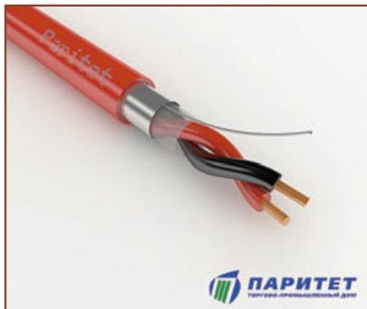
Кабели огнестойкие для систем распределенного сбора и передачи данных, применяющих стандарты RS-485 в диапазоне частот 0,03-0,750 МГц (волновое сопротивление 120 Ом), Industrial Ethernet – в диапазоне частот 1-100 МГц (волновое сопротивление 100 Ом), в системах противопожарной защиты, а также других системах управления и передачи данных на объектах повышенной пожарной опасности (метрополитен, промышленные предприятия, школы, больницы, офисные помещения, высотные здания).
