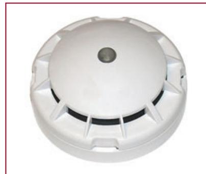
Извещатель пожарный дымовой оптико-электронный взрывозащищенный с системой самотестирования, 130 мкА, 0Ехi-aIICT6, IP40, t<sub>раб.</sub>: от -30 до +70° С. Извещатель предназначен для обнаружения загораний, сопровождающихся появлением дыма в закрытых помещениях офисов, магазинов, банков, складских помещений, жилых домов, учреждений и предприятий. Используется для работы с неадресными лучевыми пожарными и охранно-пожарными приборами во взрывозащищенном исполнении.
