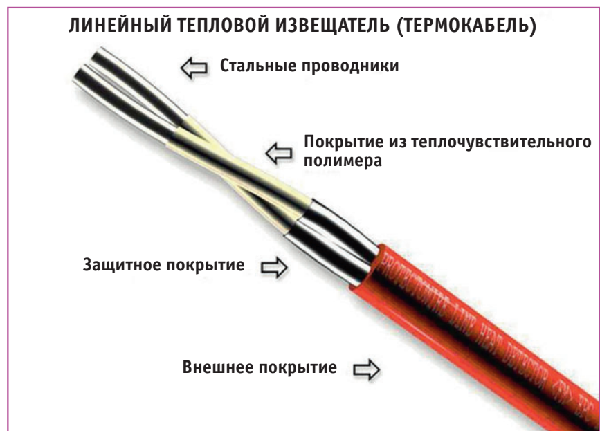
Рис. 1. Структура теплового линейного пожарного извещателя контактного принципа действия
