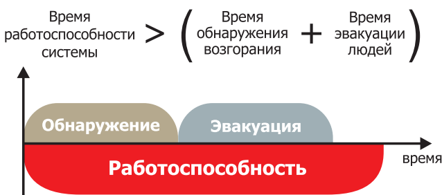
Рис. 1. Время сохранения работоспособности систем противопожарной защиты в условиях пожара
