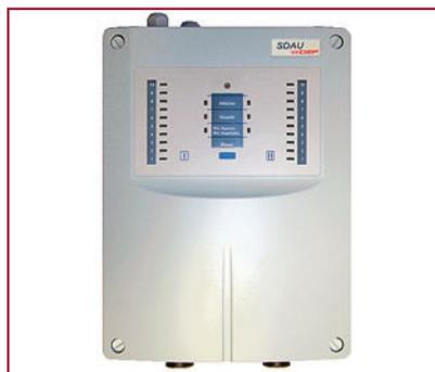
SDAU – это высокочувствительный аспирационный дымовой извещатель, состоящий из одной или двух сетей аспирационных трубок с пробоотборными отверстиями, каждая из которых имеет высокочувствительный дымовой датчик.
