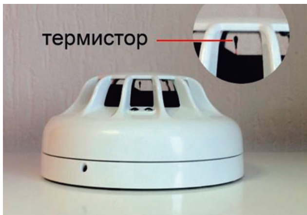
Рис. 1. Термистор мультикритериального дымового извещателя с тепловым каналом
