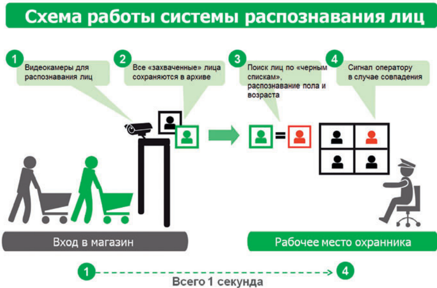
Рис. 1. Схема работы систем распознавания лиц в ритейле
