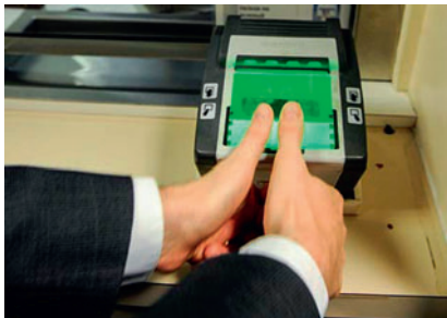
Рис. 8. Сканирование сразу двух отпечатков пальцев
