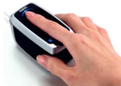
Рис. 10. Гибридный сканер нового поколения анализирует одновременно отпечаток пальца и строение вен пальца
