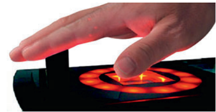
Рис. 3. Устройство для регистрации строения вен руки человека
