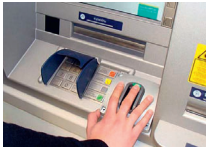
Рис. 9. Банкомат фиксирует клавиатурный код и строение вен пальца
