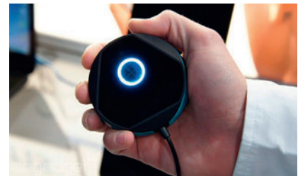
Рис. 5. Регистратор радужной оболочки глаза (встроен в «мышь» ПК)
