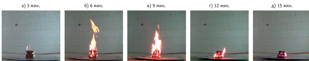
Рис. 11. Уменьшенный в 10 раз очаг ТП-1
