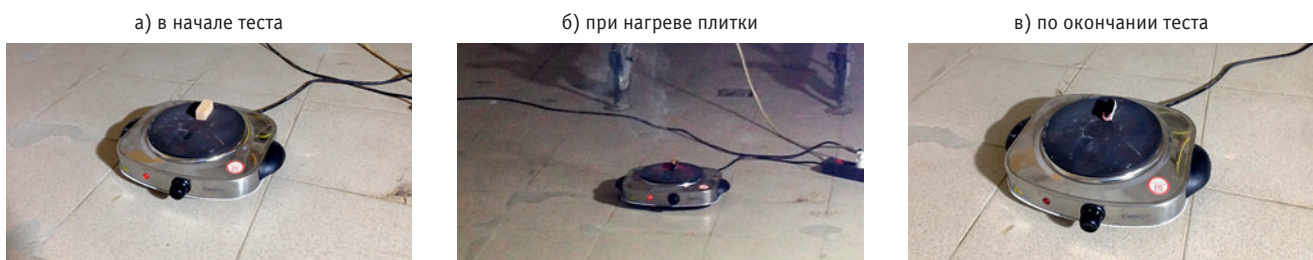
Рис. 14. Уменьшенный в 18 раз тестовый очаг ТП-2
