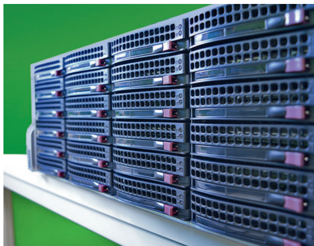
Рис. 2. Классическое решение для СБ – локальные дисковые массивы для хранения архивов в видеосерверах
