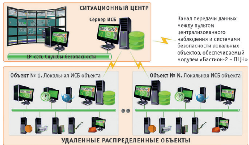
Рис. 1. Схема двухуровневой распределенной системы безопасности с использованием АПК «Бастион-2»
