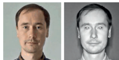
Рис. 3. Видеоизображения, сформированные при естественном освещении и инфракрасной подсветке
