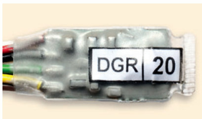
Рис. 3. Микромодуль в компаунде. Может работать даже в воде
