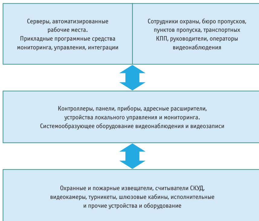
Рис. 1. Типовая организационно-техническая архитектура КСБ
