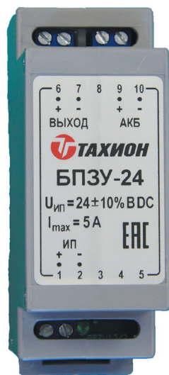
Рис. 5. Блок переключения питания с зарядным устройством
