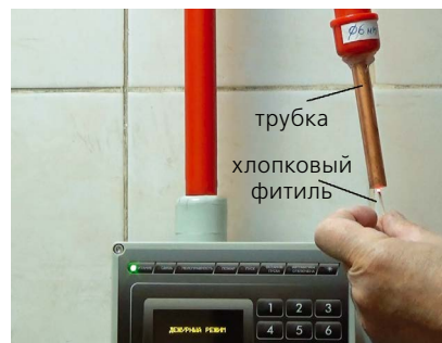
Рис. 5. Тление хлопкового фитиля в трубке \varnothing 10 мм
