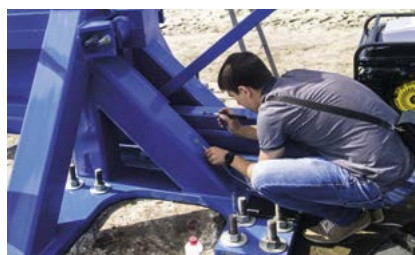
Рис. 5. Установка датчиков на испытываемую модель
