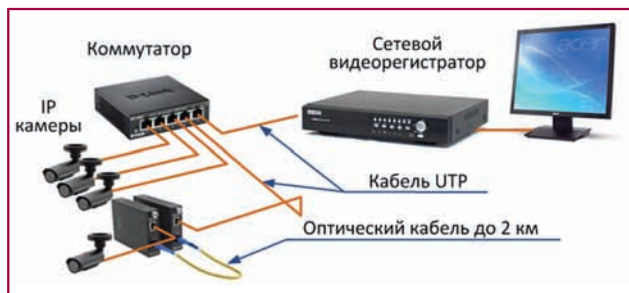
Рис. 9. Схема удаленного (до 2 км) подключения четырех IP-камер к сетевому видеорегистратору по оптоволоконному кабелю
