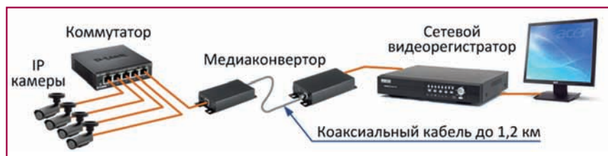
Рис. 11. Схема удаленного (до 1,2 км) подключения четырех IP-камер к сетевому видеорегистратору по коаксиальному кабелю
