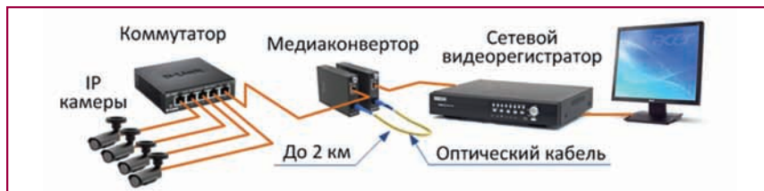
Рис. 9. Схема удаленного (до 2 км) подключения четырех IP-камер к сетевому видеорегистратору по оптоволоконному кабелю
