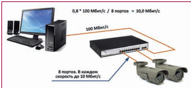
Рис. 7. Допустимые скорости потоков на порт при использовании комбо-порта
