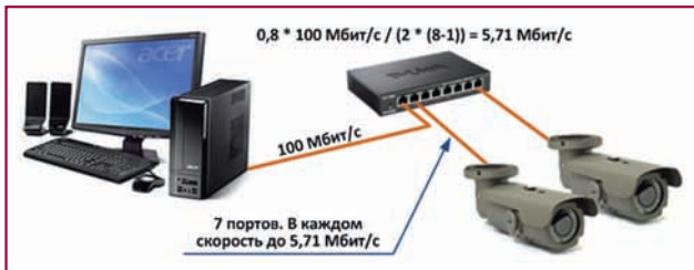
Рис. 6. Допустимые скорости потоков на порт при использовании простого коммутатора
