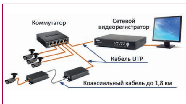
Рис. 13. Передача по коаксиалу сигнала от CCTV и IP-камер до 600 м
